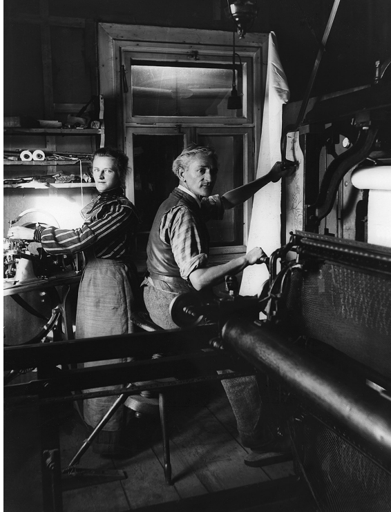
Abb. 11 Heimstickerei. Frau fädelt, Mann stickt an der Schifflistickmaschine, um 1910. Schweizerische Nationalbibliothek Bern, Archiv Photoglob-Wehrli
