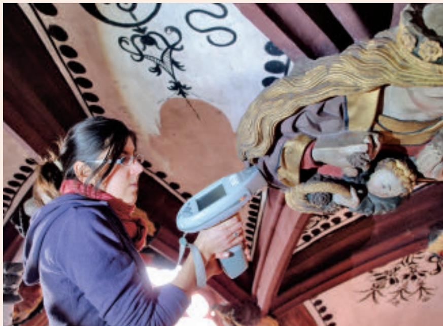
**Abb. 7** Berührungsfreie Analyse der Farbfassung mithilfe der XRF-Spektroskopie (Röntgenfluoreszenzanalyse / X-ray fluorescence spectroscopy) an Stellen, wo nach der detaillierten restauratorischen Befundaufnahme noch spezifische Fragen offen waren. Durch diese Voruntersuchungen konnte die benötigte Zahl an Laborproben im Chorgewölbe sehr klein gehalten werden. Im Bild: Rowena Pasche, Restauratorin der Münsterbauhütte. © Berner Münster-Stiftung
