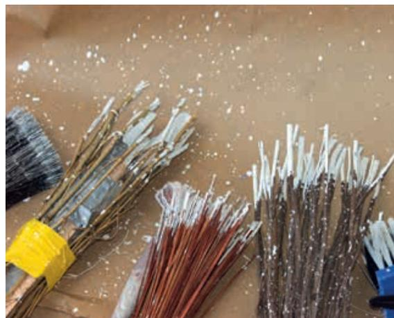
**Kirche San Giachem in Bever GR.** Die Steinsprenkel wurden mit Bürsten und mit unterschiedlichen und selbsthergestellten «Rutenbesen» von Hand mit Mineralfarbe auf den Untergrund aufgespritzt (links). Das Eingangsportal mit heller und dunkler Steinimitationsmalerei, Schlusszustand (rechts). Verwendetes Werkzeug, Bürsten und selbst angefertigte «Rutenbesen» zum Aufspritzen der Farbsprenkel auf die Putzoberflächen. Fotos Marius Fontana
