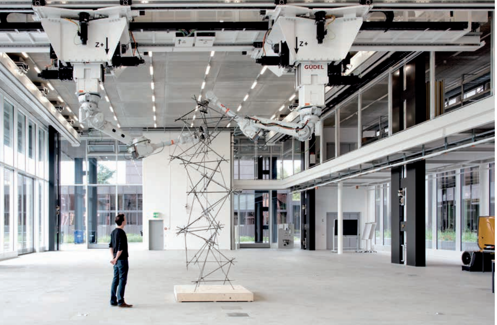
Abb. 5–7 «Entwurf und Robotische Assemblierung von Räumlichen Strukturen» bei Gramazio Kohler Research, ETH Zürich. Drei Teststrukturen, welche anhand des gleichen digitalen Modells, nur durch das Ändern der Entwurfsparameter, generiert und gebaut wurden. Foto Gramazio Kohler Research, ETH Zürich, 2018
